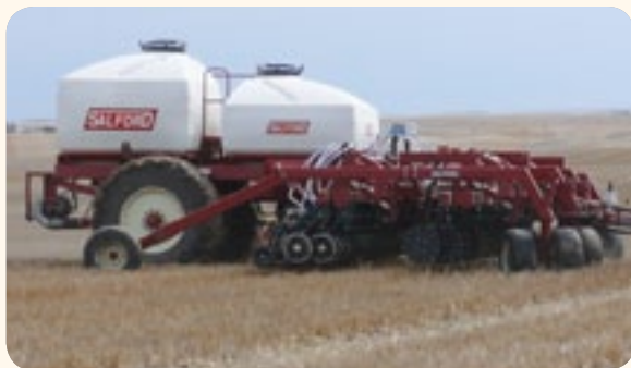
■ Двойной бункер, смонтированный на раме
