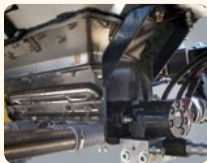
■ Гидромотор плавного регулирования нормы высева с контролем от компьютера
