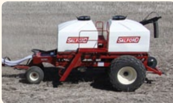
■ AC 2000 2-х емкостной бункер до 13 куб. м
