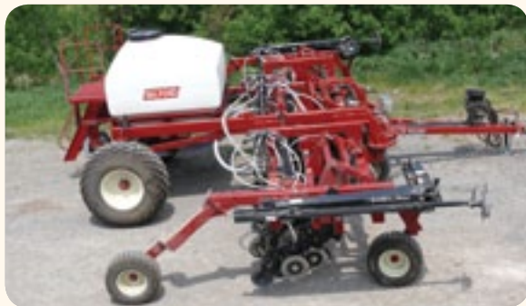
■ Одиночный бункер с 1-м рядом рабочих органов
