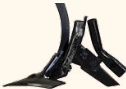
■ Сошник широкополосного посева в спаренные рядки с раздельным внесением удобрений.
