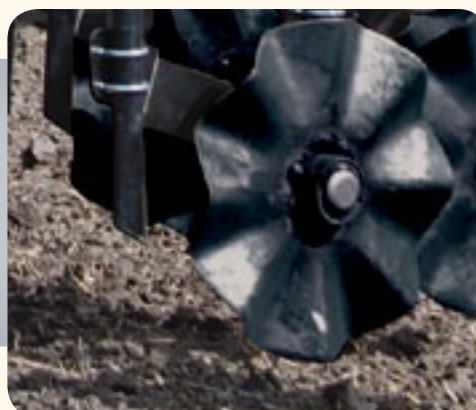
■ Култер с инжектором для внесения удобрений
