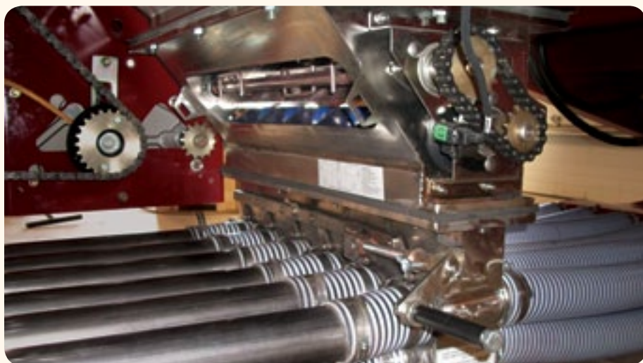
■ Переключатель раздельное/совместное внесение удобрений с возможностью смешивания
