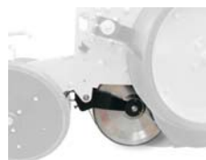
промежуточное прикатывающее колесо, прорезиненное или металлическое
