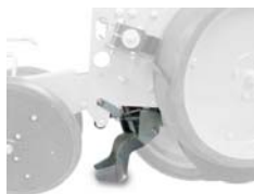
промежуточный загорточ с регулировкой
